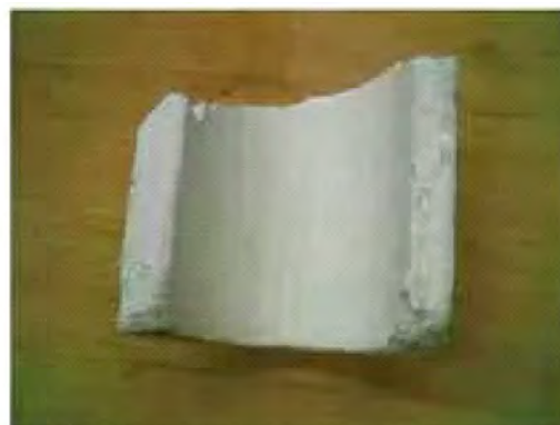
شکل ۲- عایق سیلیکات کلسیم
